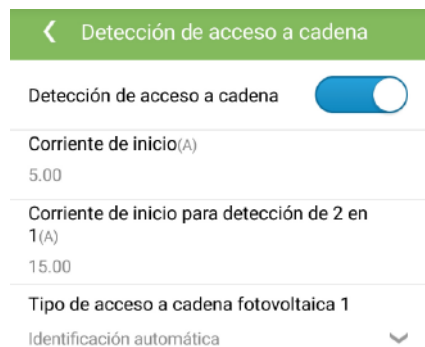
Figura 7-11 Detección de acceso de string
